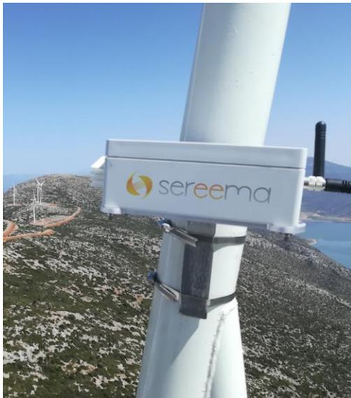
Pour répondre à cette nouvelle problématique, Sereema a conçu une solution experte pour l'analyse et l'optimisation du fonctionnement des turbines éoliennes. Ce système propriétaire comprend une sensor box IoT équipée de capteurs MEMS qui s'embarquent dans l'éolienne, une plateforme de stream processing avec ses propres algorithmes et un site web utilisateur qui présente tous les tableaux de bord utiles.
